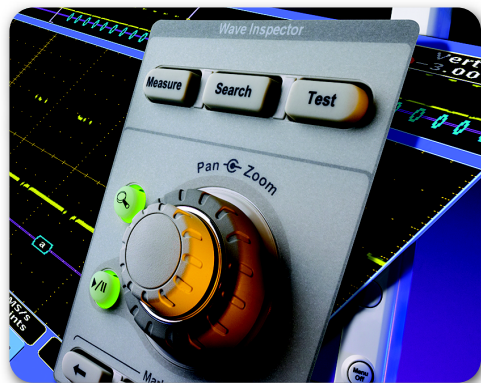
► 图 3. 直观的 Wave Inspector® 控制功能。
